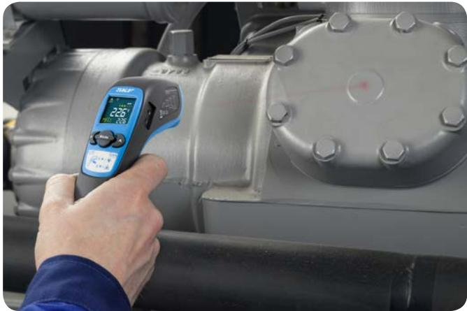
使用非接触测量模式时，测温仪通过热敏传感器检测从目标物体辐射出来的热能。将红外测温仪指向目标物体，热敏传感器收集能量，转换成信号，经微处理芯片的处理显示在有背光的显示屏上。扣住扳机，热敏传感器会连续地测量目标物体的温度，这样就可以快速获得精确的实时读数。
